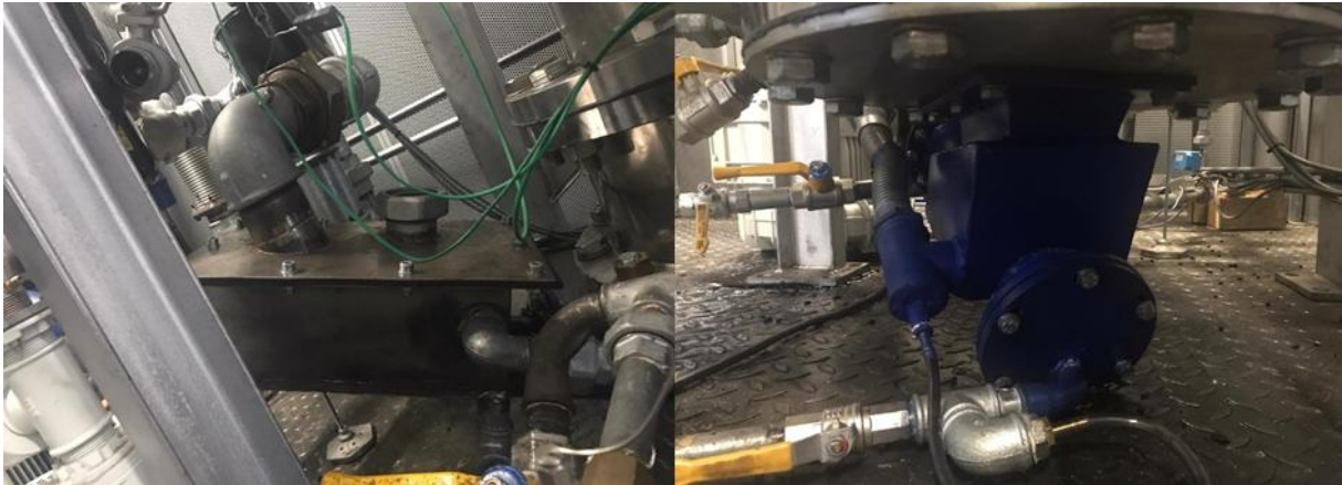
Abbildung 4.3: Modifizierter Gasaustrag zur Minderung der Kondensation (hier ohne Isolierung)
