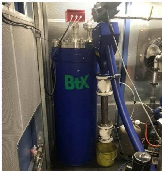
Abbildung 4.5: Prototyp des neu entwickelten Wassergas-Shift Reaktors für Holzgas „Slim Shifty“ im Container der Holzvergaseranlage.
