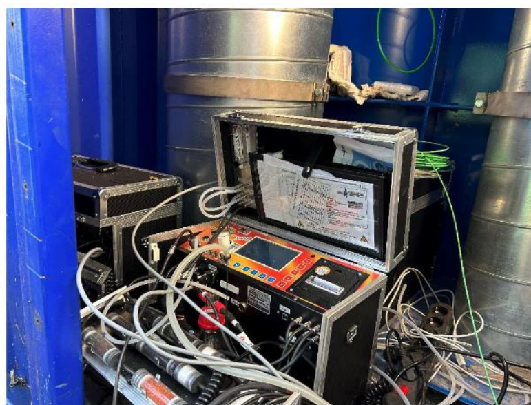
Abbildung 4.4: Gasanalysegerät an Messstelle 3 mit Verschlauchung und Gasaufbereitung; links daneben ist das Gerät von Messstelle 5 zu sehen
